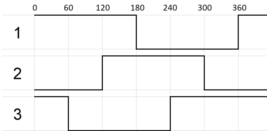
4-18. ábra. Az Arduino három digitális lábának értéke a fázis alapján
