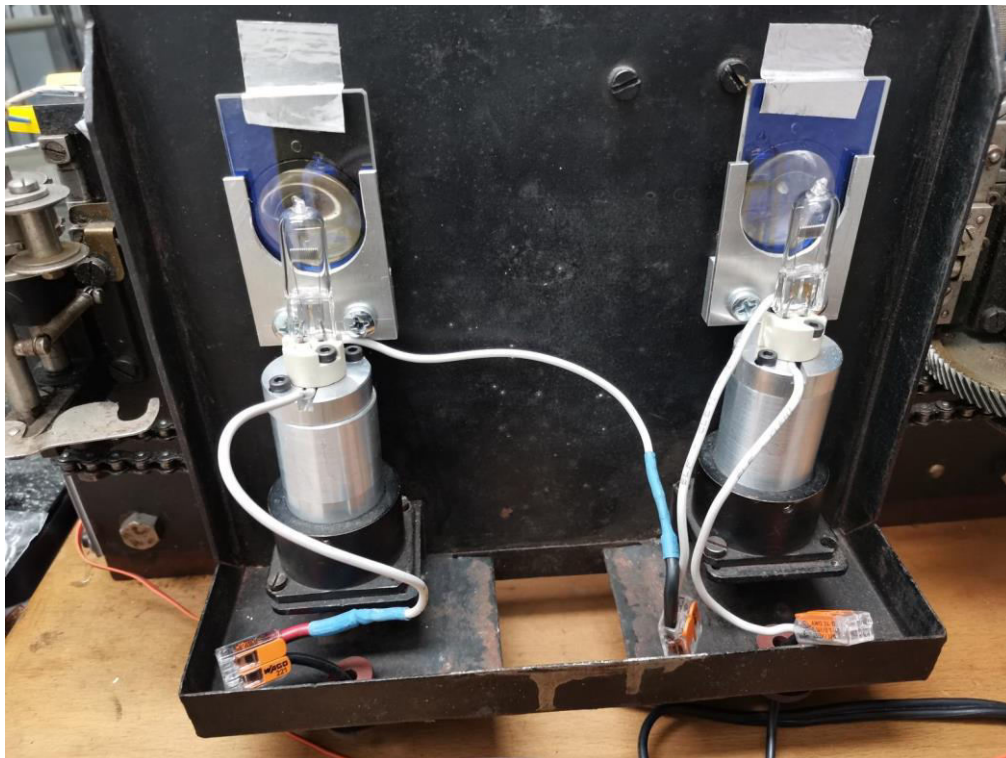
4-13. ábra. A hőszűrőűvek beszerelt állapotban
