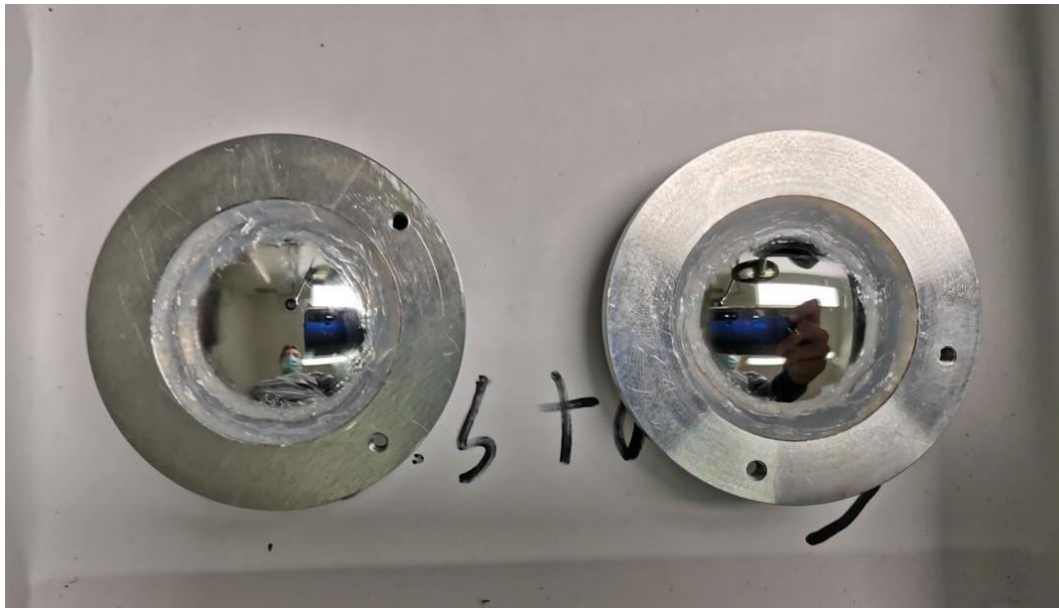
4-8. ábra. A tükörtartók és a tükrök összeragasztva
