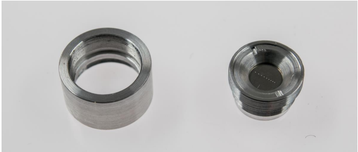
30. ábra: C-előtét (balra) és lencsetartó (jobbra) lézervágott ábrával szerelve
