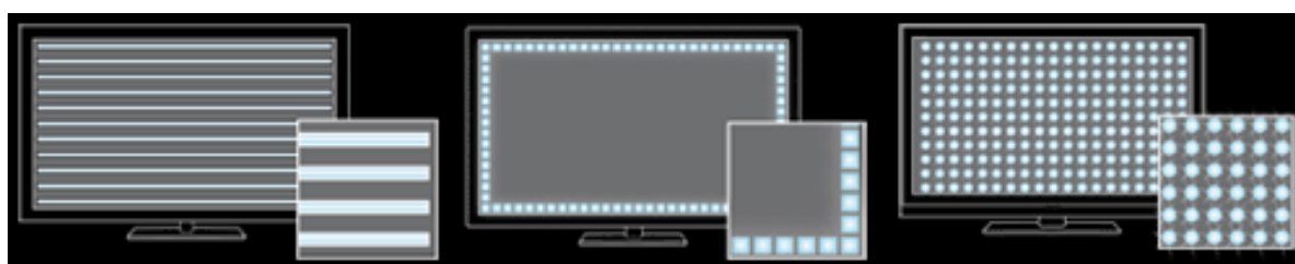
15. ábra A CCFL, az Edge LED és Full LED háttérvilágítás különbségének szemléltetése [60]
