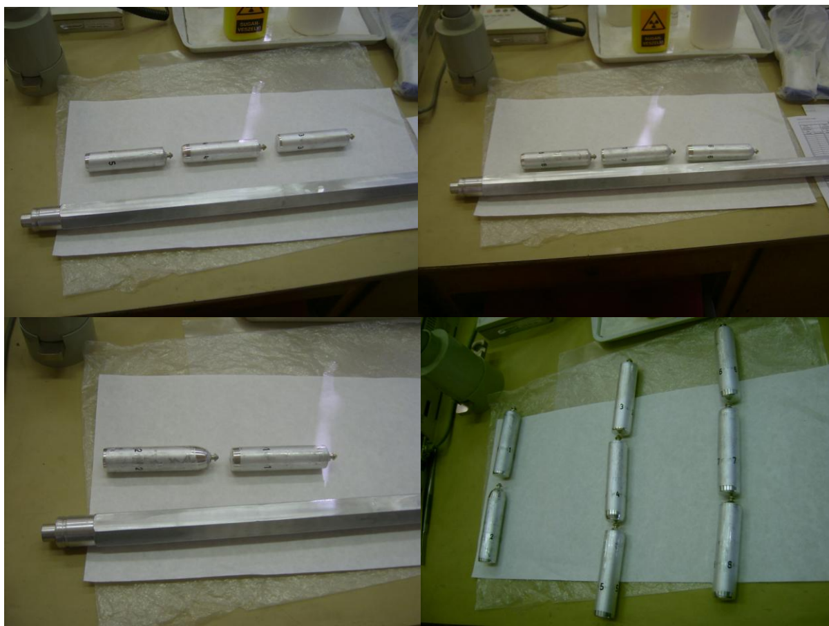
8. kép Tubusok elhelyezkedése a csövön belül
