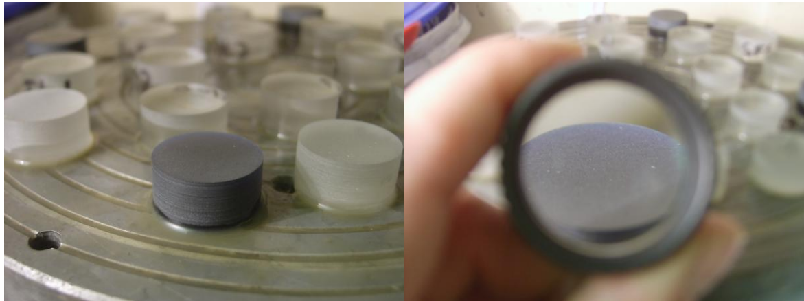
5. kép Csiszolás után lupával ellenőriztem a felületi egyenletességet
