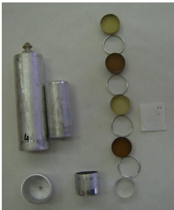
9. kép 4.tubus összeállítása felbontás után
