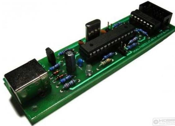
20. ábra: AVR-Doper, USB-s ISP programozó
