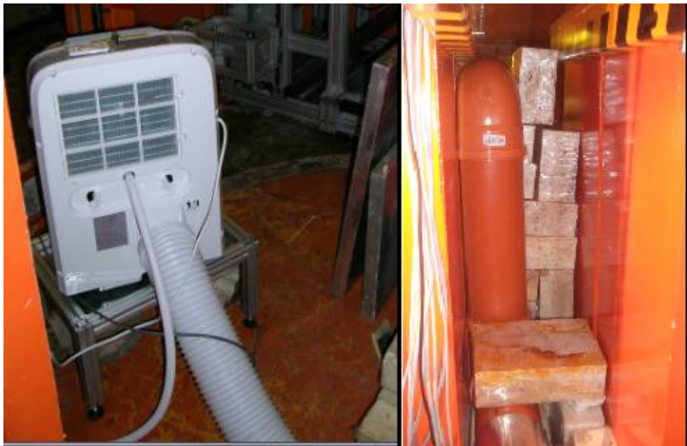
60. ábra A mobilklíma az emelvényén, látszik a légkiömlő nyílás és a légbeszívó harmonikus vezeték és a mérőszobába a légbevezetés
