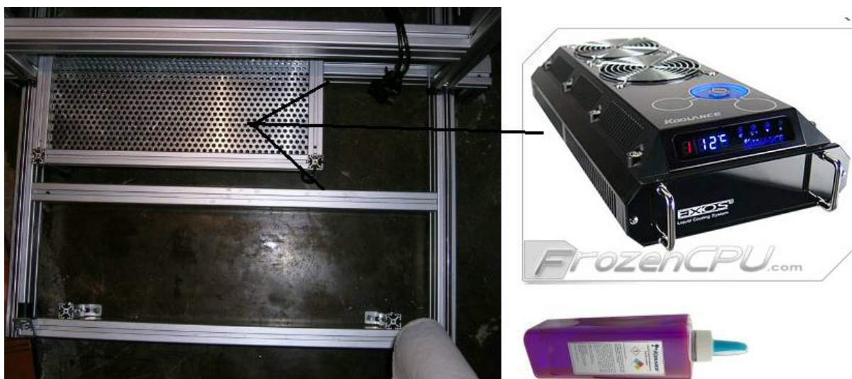
58. ábra baloldali: a vízhűtés helye a mozgató asztal alatt, jobboldali: Koolance EXOS 2 és a hozzátartozó folyadék
