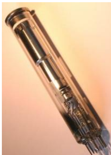
11. ábra Napjainkban is kapható vidikon cső
