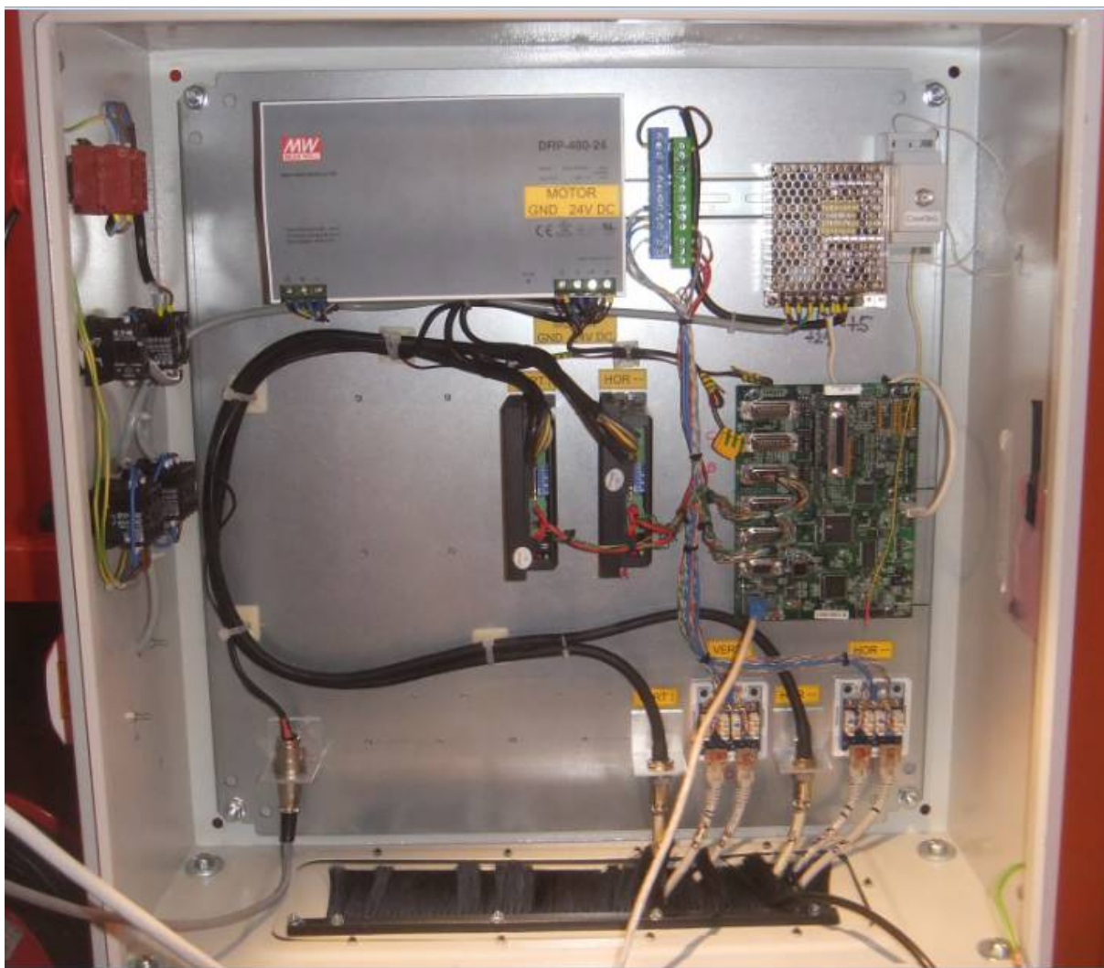
63. ábra A kapcsoló szekrény belseje. Kapcsolók, motor- és Galil táp, földelés, motor vezérlő Galil és végfok, és összeköttetésük a motorral és a szenzorokkal.
