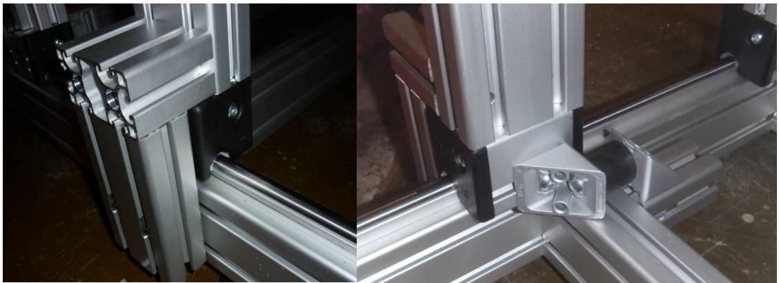
65. ábra kipörgés gátló, ami az asztal felborulását akadályozza és a gumi ütköző, ami a berendezés lefutását akadályozza
