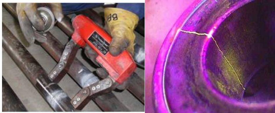
6. ábra Mágneses repedés vizsgálat, és a megjelenített repedés
