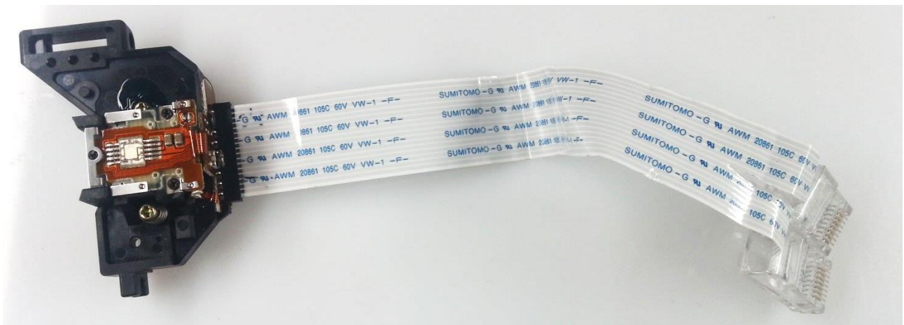
22. ábra A CD-fej a kialakított UTP-kábellel
