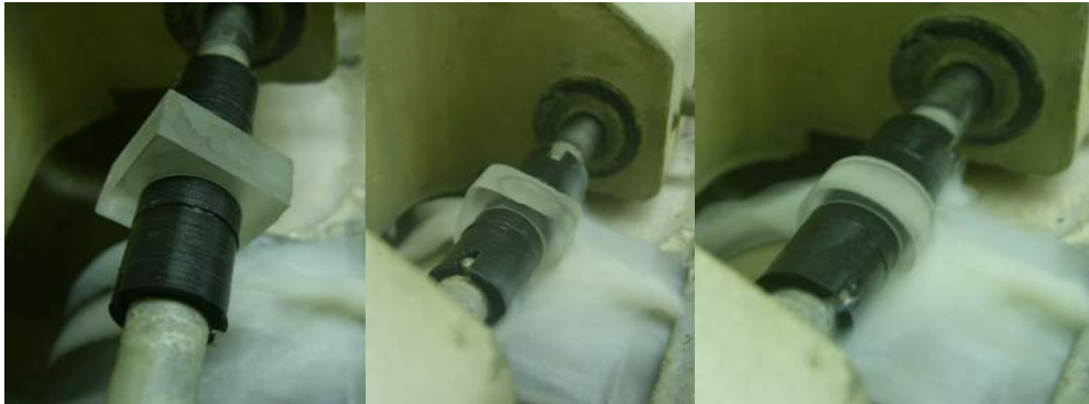
3. kép Gömbölyítés folyamata , BK7-es üveg (10mm vastag, 20mm átmérőre)
