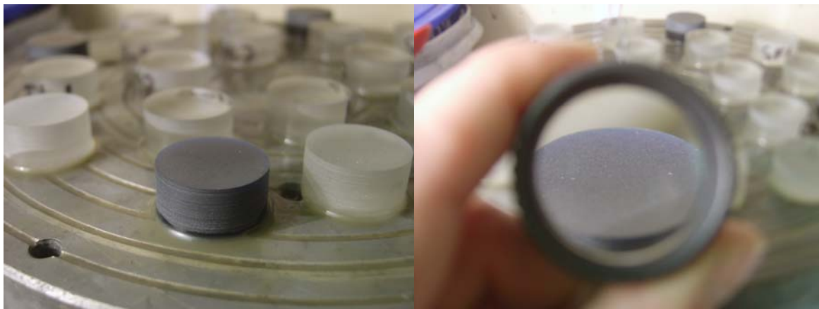
5. kép Csiszolás után lupával ellenőrztem a felületi egyenletességet
