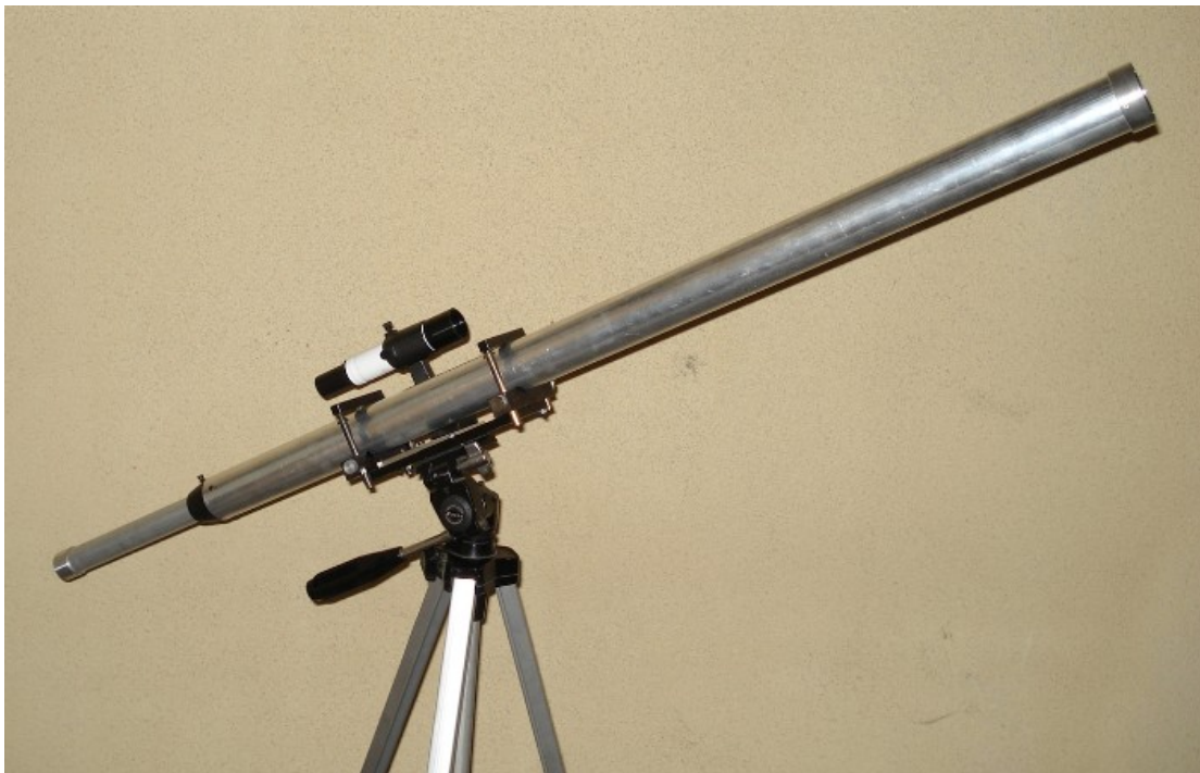
9. ábra Az elkészített távcső állványon, kererőtávcsővel
