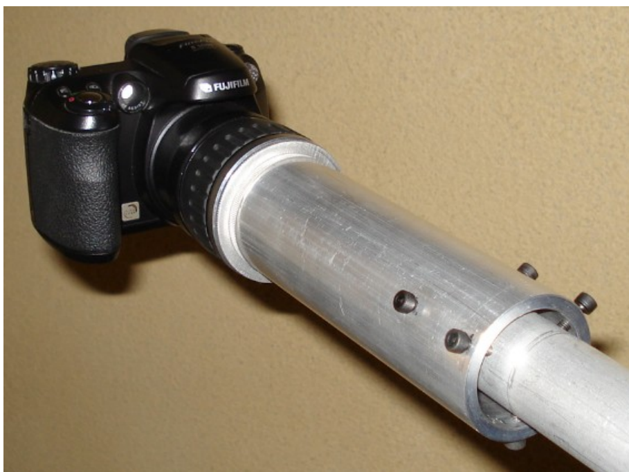
25. ábra Fényképezőgép rögzítése a távcsőre
