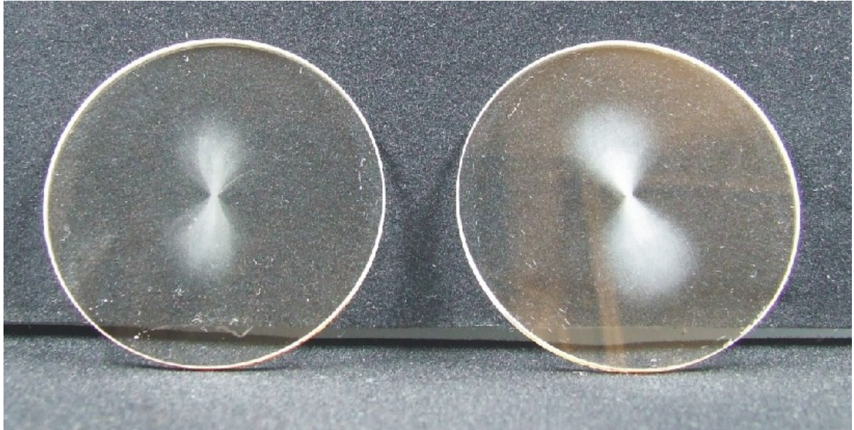
15. ábra Lencsék leppelési nyommal, ún. lepkével
