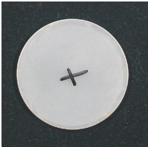
11. ábra Objektívlencse előgyártmánya, polírozás előtt
