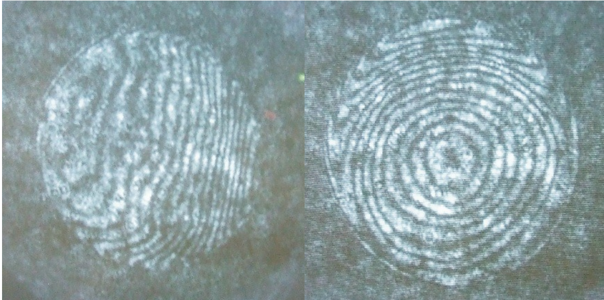
18. ábra Az 1-es (balra) és 2-es (jobbra) számú objektív interferometriás képe
