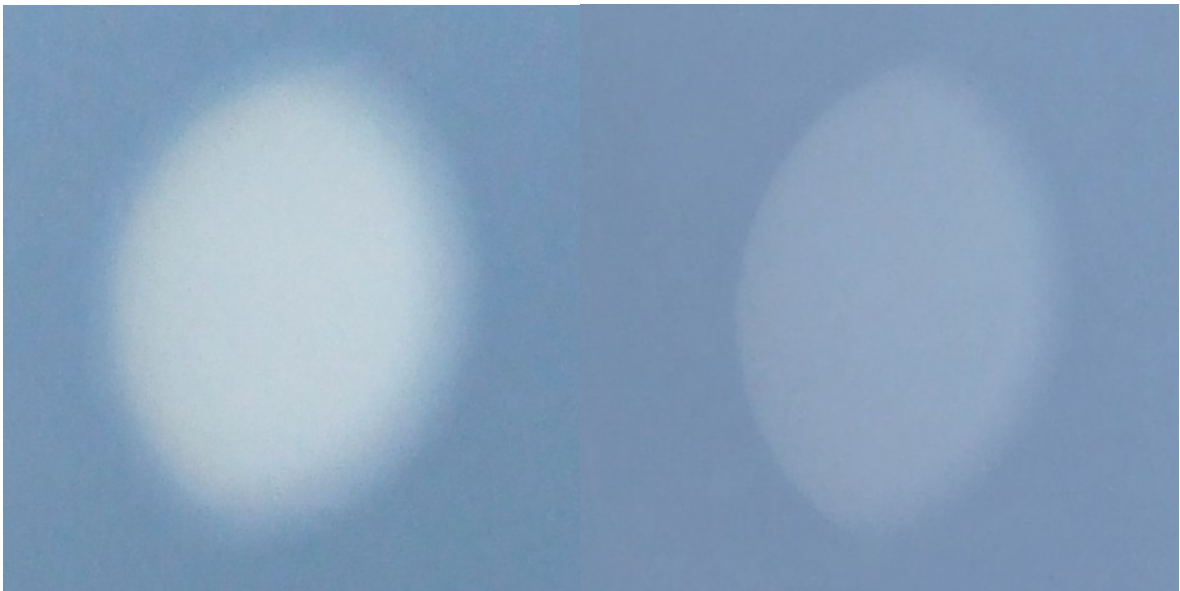
30. ábra A Nap kivetített képe rekesz nélküli (bal) és rekeszelt (jobb) képe
