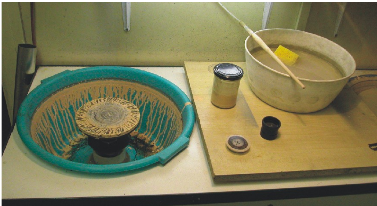
13. ábra Kézi polírozó munkaállomás az OMI műhelyében
