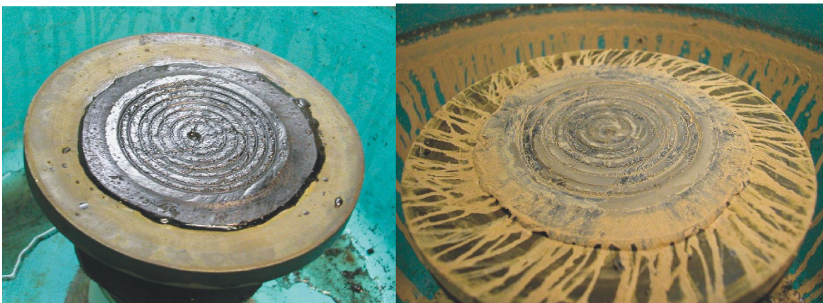
12. ábra Szurokszerszám polírozás megkezdése előtt (baloldalon) és polírozás alatt (jobboldalon)
