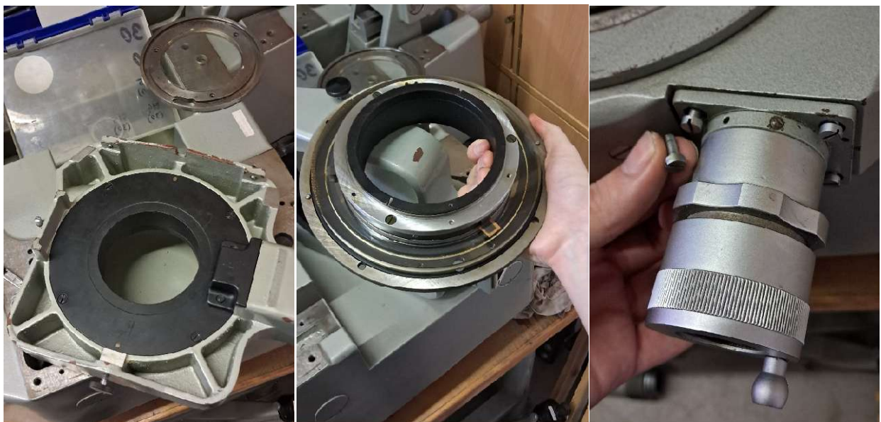
5., 6. és 7. ábra: A forgatóasztal mechanikai komponensei, a csapágyazás és az optikai elemek revíziója
