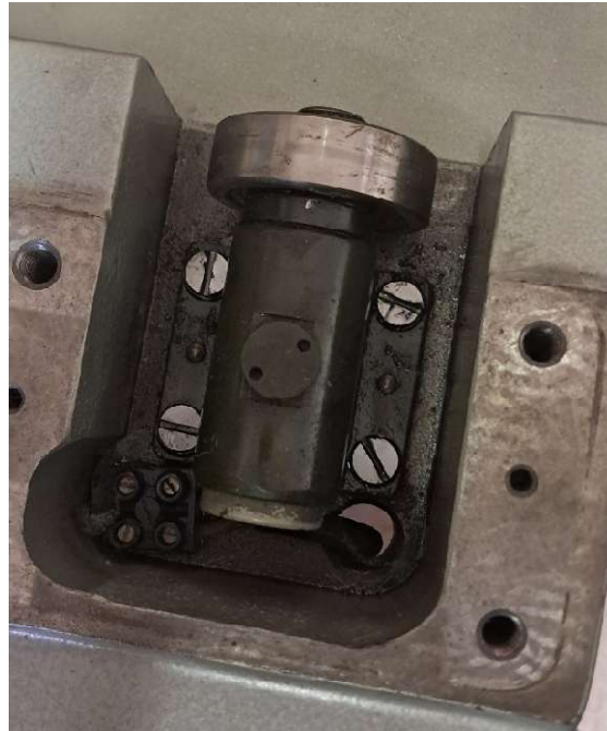
4. ábra: A pozicionáló mechanizmus precíziós csapágyazása és az excenteres szabályozóegység
