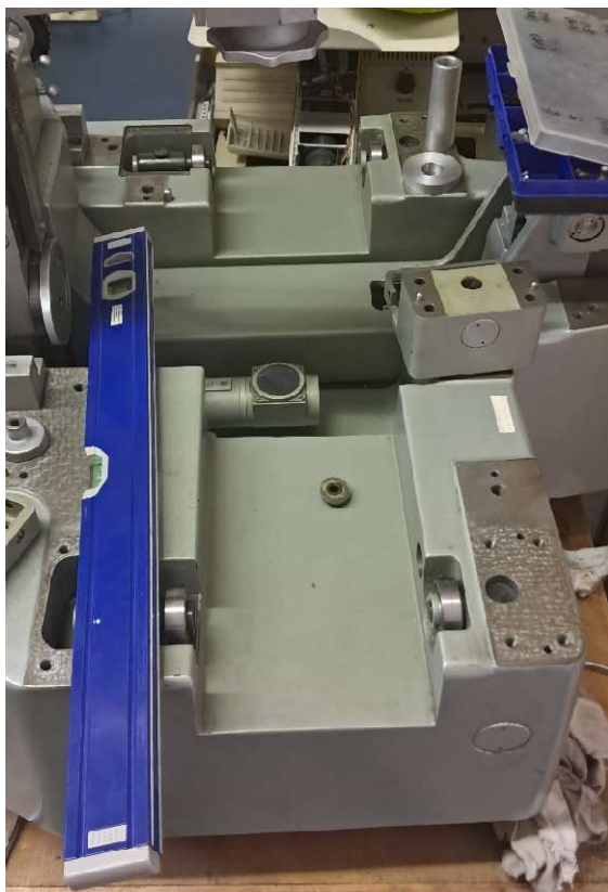
8. és 9. ábra: A csapágytengelyek és a vezetékek horizontális szintezése precíziós mérőeszközökkel
