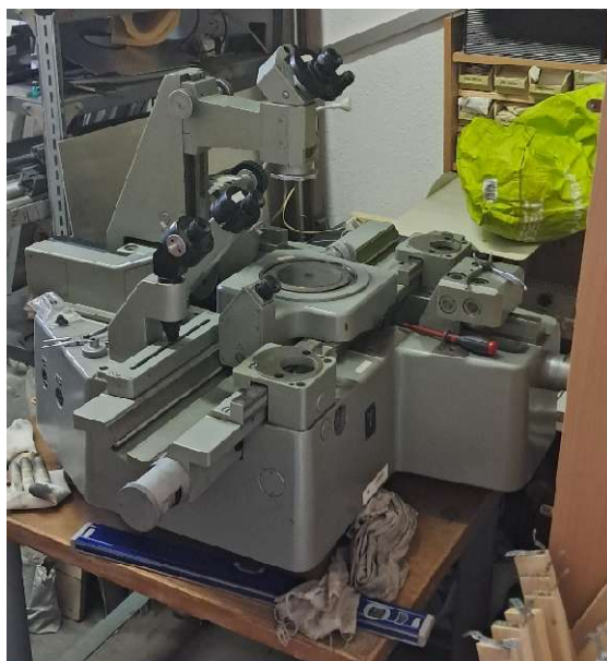
11. ábra: A teljesen összeszerelt optomechanikai alrendszer a mérőmikroszkóppal és kiegészítőivel
