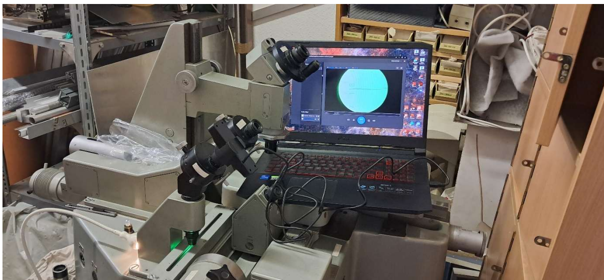
24. ábra: A mérőrendszer hardveres konfigurációja a kiértékelő számítógéppel
