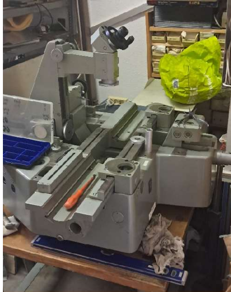
10. ábra: A hosszanti mozgatóasztal szerkezeti integrációja
