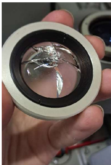
16. ábra: Termikus túlterhelés következtében tönkrement (repedt) kondenzorlencse
