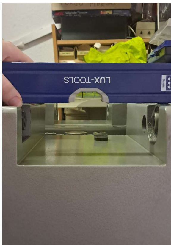
8. és 9. ábra: A csapágytengelyek és a vezetékek horizontális szintezése precíziós mérőeszközökkel
